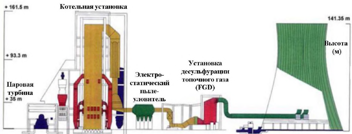
Рисунок 7.1 — Схема совместного парогазоудаления на ТЭС
